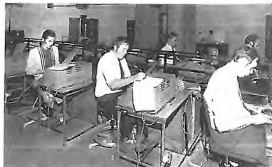
Fig. 70 ZT - Le macchine per composizione elettronica alleviano notevolmente il lavoro dell'operatore; nelle redazioni dei giornali assai spesso è il giornalista stesso che da il via all'operazione con la sua prima battuta del testo che l'elaboratore centrale si incaricherà di suddividere, allineare, fotografare, incollare, ecc.
