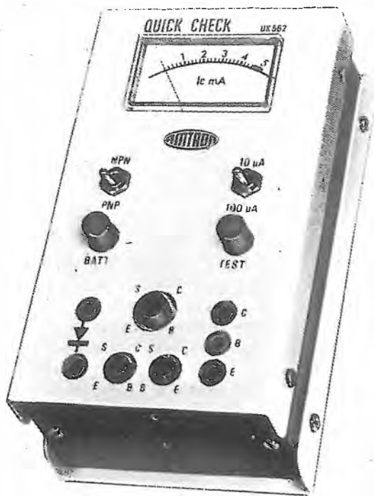
Fig. 25 QR - L'efficienza di un transistor può essere rapidamente appurata misurandone il « beta », ossia il coefficiente di amplificazione. Questo strumento non si limita all'indicazione di un cortocircuito o di un'interruzione interna ma permette di valutare anche la funzionalità. È leggero, compatto, autoalimentato, facilmente portatile.
