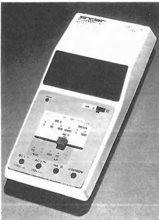
Fig. 83 ZT - Multimetro digitale portatile del tipo a rampa singola. Adotta 4 circuiti integrati di cui uno apposito. La frequenza d'orologio è di 10 kHz e l'oscillatore — dalla cui stabilità dipende la precisione — è a compensazione di temperatura. Misura tensione continua ed alternata sino a 1000 V, corrente c. sino a 100 mA e resistenza sino a 10 M \Omega . Precisione dell'1% su visualizzatore e 3½ cifre.
