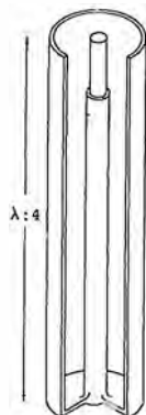
Fig. 15 LM - Tipica linea risonante, coassiale, rigida (veduta, in parte sezionata) in tubo metallico. La lunghezza è pari ad un quarto d'onda. Si noti la possibilità di modificare, ad una estremità, la lunghezza del conduttore centrale.
