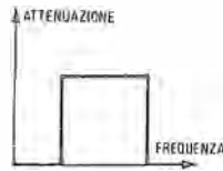
F - In un filtro ideale il passaggio della zona passante a quella interdetta e viceversa deve essere immediato, come in figura, e cioè senza le zone di transizione che, in pratica si hanno quasi sempre.
