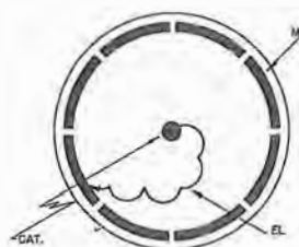
Fig. 47 LM - All'interno del magnetron a placca risonante gli elettroni (EL) seguono il percorso qui raffigurato. La placca (M) spesso è suddivisa in molti segmenti: in questo caso, otto.
