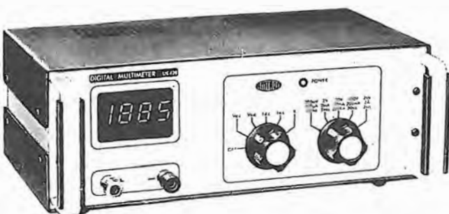
Fig. 85 ZT - A costruzione terminata l'analizzatore presenta un aspetto elegante, razionale nei comandi; pratico. Indicazione automatica della polarità. È adatto tanto per laboratorio quanto per servizio riparazioni. Pesa 1400 grammi.
