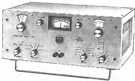
Fig. 29 EF - Ponte RCL previsto per l'impiego sia in laboratorio che nel controllo di piccole produzioni. Misura resistenze da 0,1 ohm ad 11 M \Omega ; capacità da 1 pF a 1 100 \mu F; induttanze da 10 \mu H a 1 100 H; fattori di merito e fattori di potenza. La precisione di misura è migliore dell'1 %.
