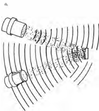
Fig. 2 ZT - Due trasduttori possono corrispondere oltre che direttamente anche a mezzo riflessione delle onde da parte di un oggetto riflettente: è un fenomeno che ha una certa analogia col principio radar, qui trasferito alle onde ultracustiche.
