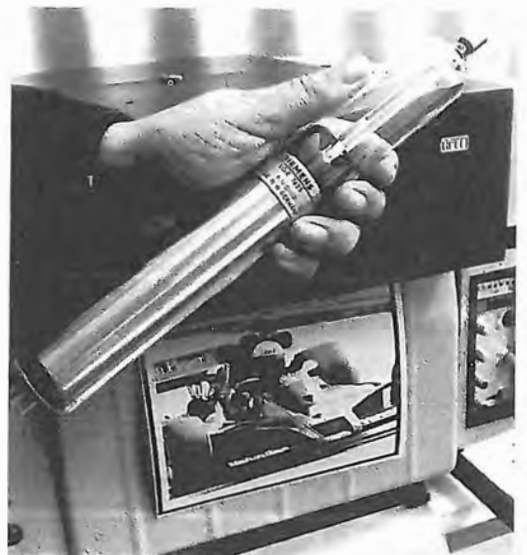
Fig. 66 ZT - L'impiego di luce laser ha apportato grandi vantaggi alle apparecchiature per teletrasmissioni di fotografie. Il tubo qui mostrato (elio-neon) grazie ad una speciale geometria del risonatore ed a particolari varianti di pressione del gas ha raddoppiato la sua capacità di modulazione iniziale.
