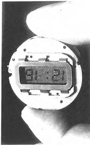
Fig. 30 ZT - Gli orologi da polso hanno trovato nell'affissione a cristalli liquidi una soluzione ideale grazie al bassissimo consumo di cui questa tecnica beneficia. Nella figura si può notare la formazione delle cifre mediante segmenti (vedi figura 28 ZT).
