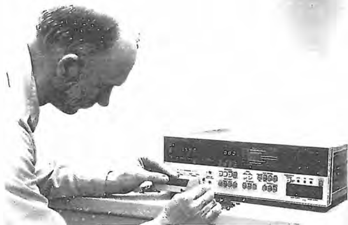
Fig. 31 EF - Ponte RCL con microprocessore incorporato. Con la messa in funzione dello strumento si ha il posizionamento automatico di tutti i parametri che interessano.
