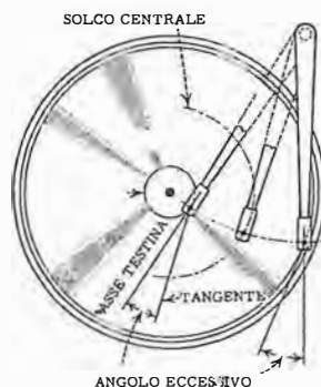
Fig. 30 GH - A sinistra, tre posizioni di un braccio dritto che mostrano come, solo per una posizione (solco centrale) non si verifichi errore tangenziale: esso è notevole, invece, sulle due posizioni estreme. Più il braccio è lungo, maggiore è l'inconveniente. A destra, orientando la testina verso l'interno (o curvando il braccio) l'angolo d'errore può essere ridotto ad un valore accettabile.
