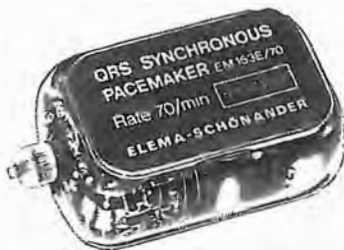
Fig. 50 ZT - « Pacemaker » per applicazione interna: misura 71 x 46 x 24 mm, pesa 120 g; è rivestito (compresi gli elettrodi d'acciaio) in resina epossidica. Il controllo del funzionamento dello stato batterie può essere eseguito con un magnete esterno.
