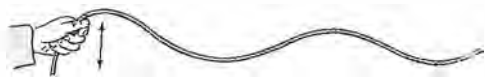
Fig. 2 NP - Le oscillazioni generate dal movimento della mano si allontanano dalla fonte propagandosi nel mezzo ed evidenziandosi sullo stesso in misura decrescente.
