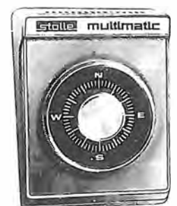
Fig. 52 NP - Antenna per TV, con rotore. La manopola di comando (accanto) è dotata di lampada spia che ruota per indicare la direzione. Regime del motore: 20 V; potenza assorbita = 65 W; velocità di rotazione = 1 giro in 1 minuto.
