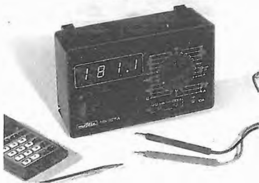
Un altro multimetro digitale con prestazioni notevoli. Il suo convertitore analogico/digitale è a doppia rampa ciò che gli conferisce un'eccellente reiezione del rumore ed una grande stabilità a lungo termine. È autoregolato per la gamma e lo zero. Alimentazione a batteria o rete. Tutte le letture sono protette.
