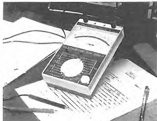
Fig. 1 EF - L'analizzatore universale è un microamperometro, molte volte con scala a specchio, corredato di resistori per renderlo idoneo alla lettura di diversi valori di corrente, di tensione e di resistenza, previo incorporamento di una pila per quest'ultima funzione. Si incontrano tipi con prese e tipi con commutatori per i cambi di portata e tipi di lettura.
