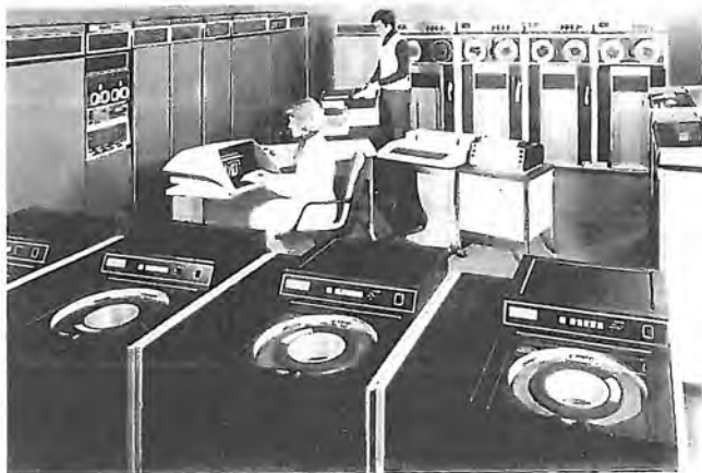
Fig. 42 RS - Elaboratore elettronico corredato di numerose memorie magnetiche. Oltre a queste si scorgono gli altri elementi (dei quali ci occupiamo più avanti) che sono tastiera, visualizzatore e stampante.
