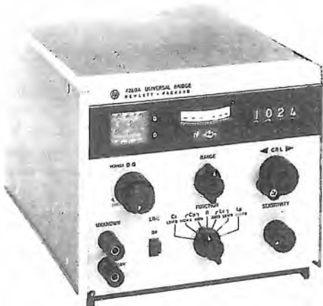
Fig. 30 EF - Questo ponte multiplo ha gamme di misura pressapoco eguali a quelle del modello di cui alla figura precedente; la sua caratteristica più rilevante è l'indicazione digitalizzata dei valori di lettura. È dotato di un particolare autobilanciamento nella misura del Q e del D (fattore di dissipazione).
