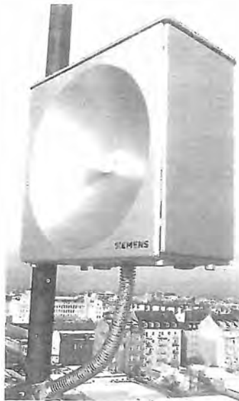
Fig. 78 LM - I terminali dei ponti radio sono oggi molto compatti. L'illustrazione si riferisce ad una custodia, da palo di 60 \times 60 cm., che può contenere 4 apparati rice-trasmittenti, operanti su frequenze diverse. Al centro l'antenna a parabola con un sub-riflettore posto nel fuoco della parabola stessa.
