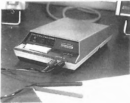
Fig. 6 EF - In alto, multimetro digitale che consente le cinque classiche misure (c.a. - c.c. tensione e corrente ed ohm). Caratterizza questo modello l'autoregolazione sulla portata, sull'azzeramento e sulla polarità; può essere autoalimentato o connesso a rete. Il modello a fianco ha prestazioni analoghe: con accessori può leggere sino a 30 kV e sino a 30 A.
