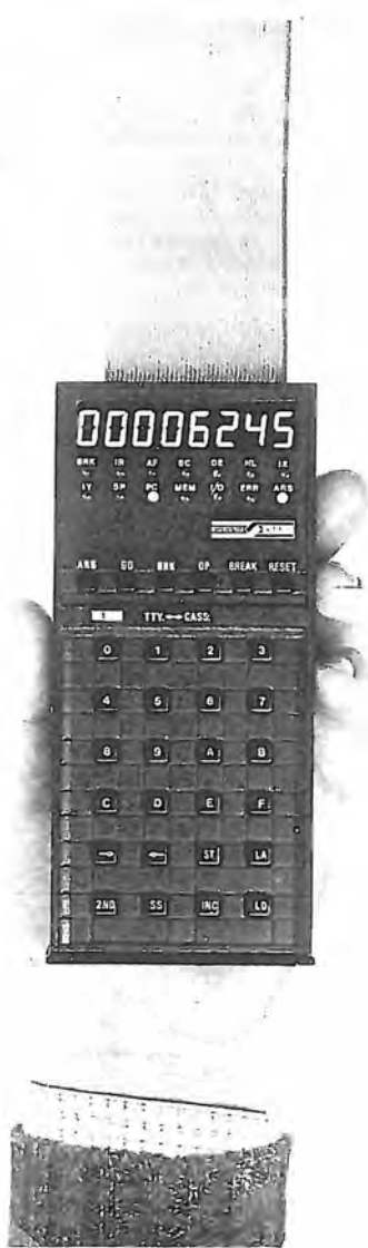
Fig. 57 RS - Un cavo piatto, flessibile, collega questo miniterminal alla scheda del microcalcolatore « Nanocomputer ». La gestione del terminale è contenuta in un programma Monitor memorizzato in una ROM. Gli otto « display » luminosi sono a 7 segmenti. Oltre ai 16 tasti dell'esadecimale vi sono 14 tasti per altrettante funzioni di controllo e gestione.
