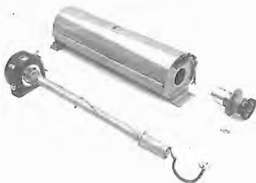
Fig. 64 LM - A sinistra valvola ad onda progressiva per ripetitori TV: guadagno = 37 dB su 800 MHz, a destra tipo per 10 ÷ 11 GHz, guadagno di 42 dB (10 w).
