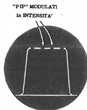
Fig. 36 QR - L'oscillatore apposito per i segnali marcatori può fornire impulsi molto stretti che, avviati a modulare d'intensità il fascio fanno sì che questo venga estinto nei punti corrispondenti alla loro frequenza.
