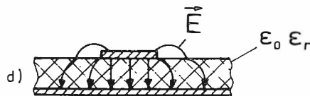
Fig. 7 LM - La microstriscia può essere vista come una particolare forma di linea bifilare. Da questa linea (a) si passa, in (b) ad un'equivalenza; si veda il comportamento dei campi E (elettrico) ed H (magnetico). Successivamente si alterano dimensioni e campi.
