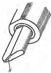
Fig. 12 GH - Il bulino è un utensile da taglio con punta terminale in zaffiro, a forma triangolare. Esso crea il solco e lo leviga: per quest'ultima azione presenta sui due lati del fronte di taglio, due piccole zone (li). Il truciolo viene aspirato da una pompa.
