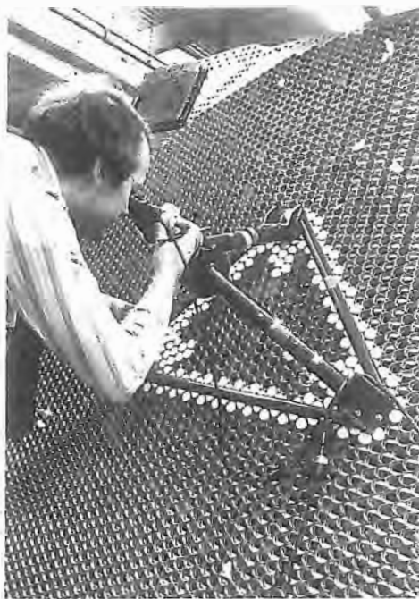
Fig. 82 LM - Antenna per radar a scansione elettronica. Si scorgono, inseriti nella struttura metallica, alcuni elementi (nel complesso sono centinaia) che risultano comandati singolarmente per dar luogo ai ripetuti sfasamenti, richiesti dal sistema.
