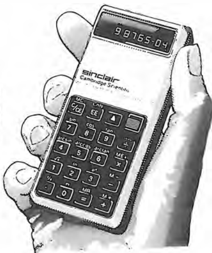
Fig. 34 RS - Le piccole calcolatrici, da tavolo e tascabili largamente diffuse, si basano sull'impiego di integrati (LSI) nei quali si accentra sia l'unità aritmetica, sia la decodifica per i diodi LED (o i cristalli liquidi) che formano le cifre, sia — quasi sempre — una funzione memoria.
