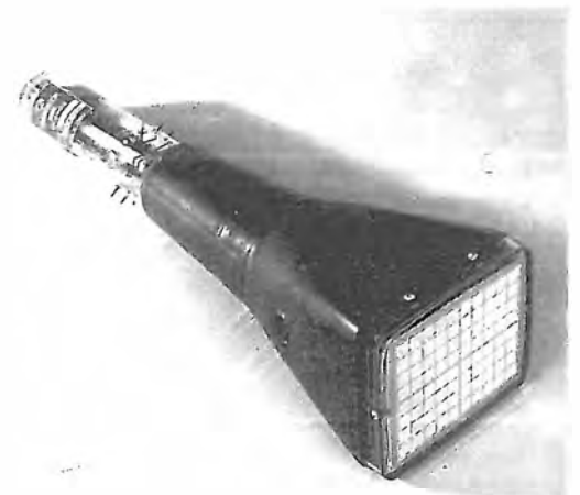
Fig. 58 EF - Un riferimento stabile, graduato, sul fronte del tubo permette l'apprezzamento di valori d'ampiezza e anche di frequenza. Quasi sempre si ha un completo reticolo, molte volte incorporato allo schermo.
