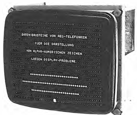
Fig. 24 ZT - Lo schermo di un tubo permette la visualizzazione di intere pagine con testi, curve, grafici, ecc. ad alta risoluzione. Vi sono anche tipi a più colori. Il video-display è indispensabile per il colloquio operatore-elaboratore.
