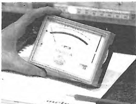
Fig. 1 EF - L'analizzatore universale è un microamperometro, molte volte con scala a specchio, corredato di resistori per renderlo idoneo alla lettura di diversi valori di corrente, di tensione e di resistenza, previo incorporamento di una pila per quest'ultima funzione. Si incontrano tipi con prese e tipi con commutatori per i cambi di portata e tipi di lettura.
