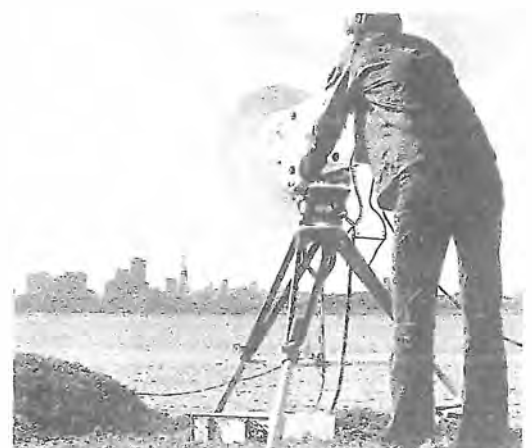
Fig 79 LM - A sinistra un posto ricetrasmittitore autonomo grazie all'alimentazione ricorrente a batterie solari. A destra un posto mobile: fornisce 1 watt di uscita da 6 a 13 GHz e 5 watt da 1,9 a 2,1 GHz.
